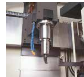
Kühlmittel durch die Spindel
