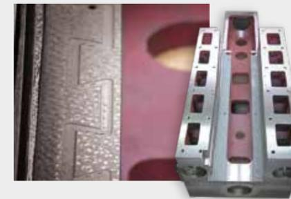
Das Kühlmittelsystem hält das Werkzeug und das Werkstück auf konstant niedriger Temperatur. Die Lebensdauer der Werkzeuge wird verlängert, wodurch die Fertigungskosten gesenkt werden. Die Führungsbahnen der Z-Achse sind induktiv gehärtet und präzisionsgeschliffen. Die gegenlaufenden Gleitflächen sind mit Turcite B beschichtet und ermöglichen eine reibungsarme Bewegung der Achsen.
