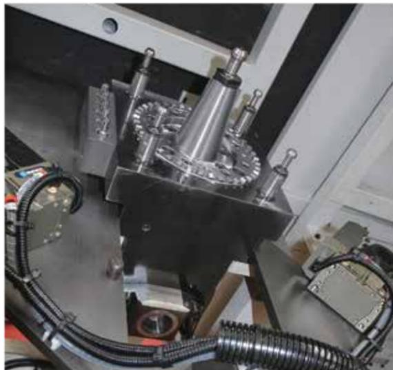
Fräswerkzeughalter mit 4 Anzugsbolzen
